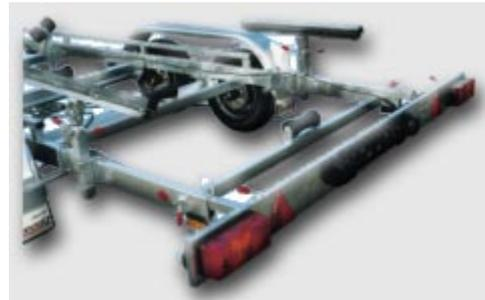
Lichtbalken mit Schiebekonsolen auszieh- und abnehmbar
